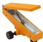
Ориентир-буссоль используется для теодолитов серии 3Т (кроме 3Т2КА) и 4Т, крепится на крышке теодолита. Погрешность ориентирования теодолита относительно магнитного меридиана 30'.
