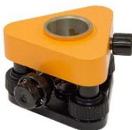
Трегер подставки имеет присоединительную резьбу 5/8" для установки на штатив. Подставки выпускаются двух типов: для теодолитов серии 3Т и 4Т.
