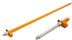
Шкала на выдвижной части вехи указывает на высоту отражателя над точкой местности. Веха снабжена круглым уровнем. Для хранения и транспортирования вехи предусмотрен чехол.
